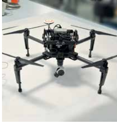
Drone quadricottero riconfigurabile con telecamera e sensori / Dipartimento di Scienze matematiche, informatiche e fisiche
