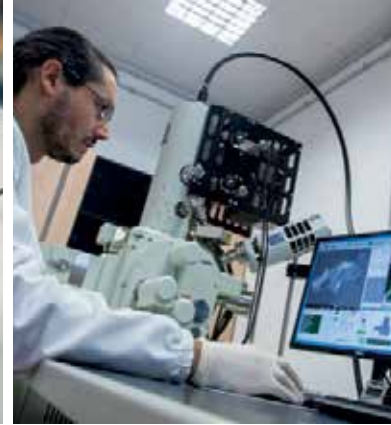
Microscopio elettronico a scansione con sorgente a emissione di campo / Dipartimento Politecnico di ingegneria e architettura
